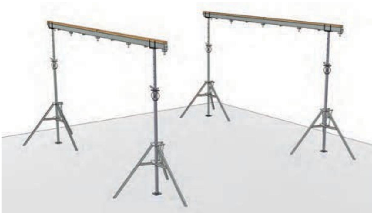
**1.** Instalación de las vigas mixtas principales y nivelación de las mismas
